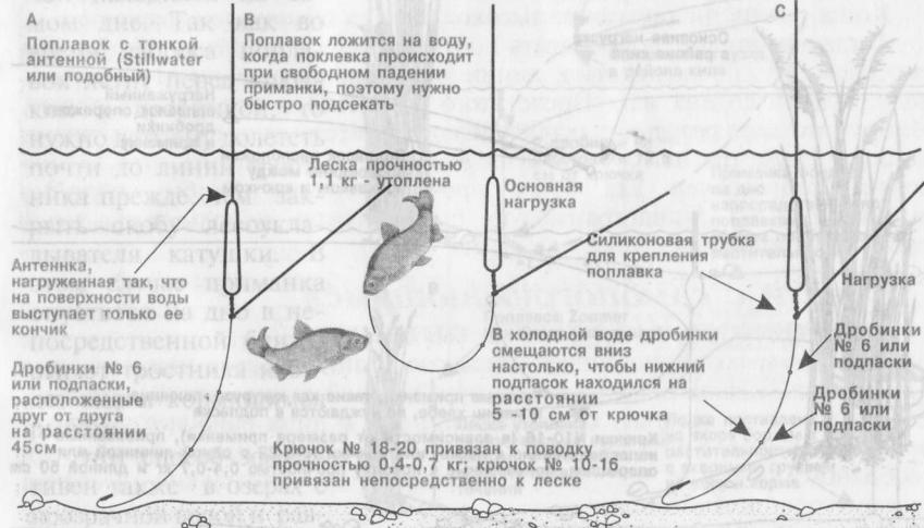
Рис. 6. Тонкая универсальная снасть для ловли в стоячей воде
